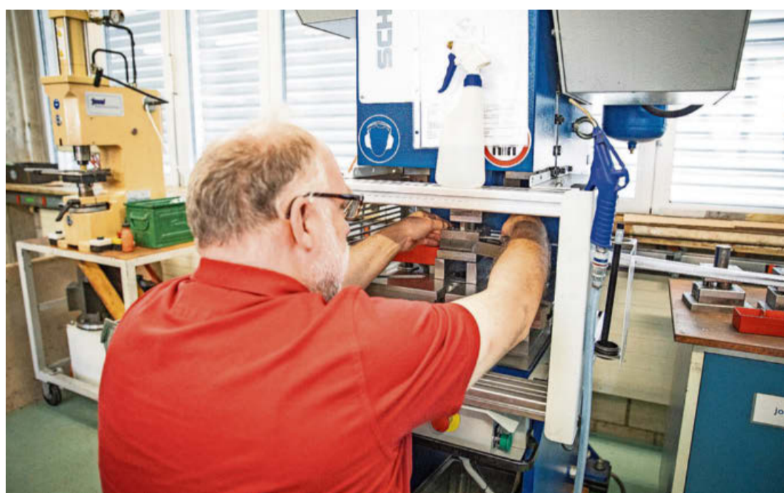
Ein grosser Teil der Lochplatten und Profile wird im Gehörlosendorf an einer Stanzmaschine hergestellt.
